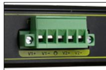
Anschluss der externen Stromversorgung (Möglichkeit der redundanten Versorgung)
