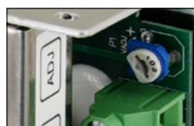
Einstellpotentiometer der Ausgangsspannung
