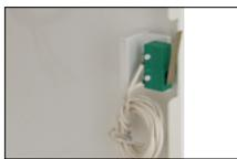
Manipulationsschutz - Öffnen des Gehäuses – 1 St.
