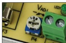
$V_{ADJ}$  Potenziometer, Regulation der Ausgangsspannung im Bereich von 12 V DC bis 15 V DC
